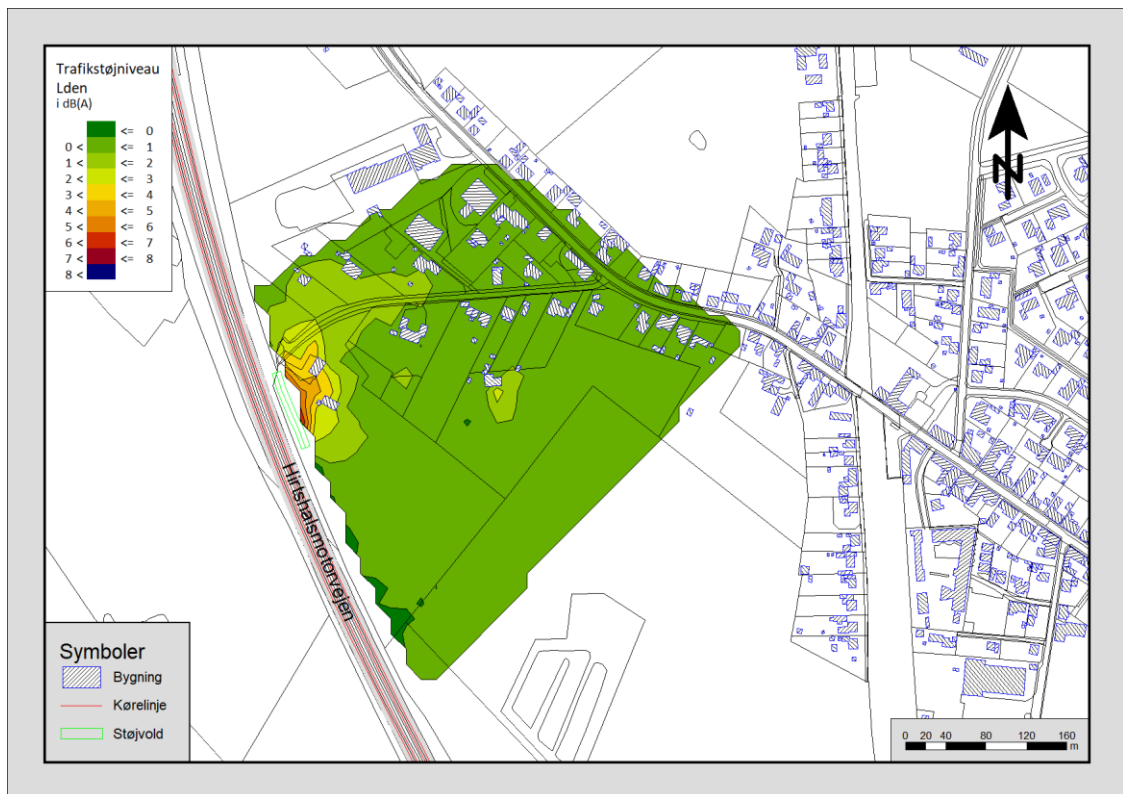
Figur 4c. Ændring med 75 meter lang vold med en topkote 5 meter over vejen
