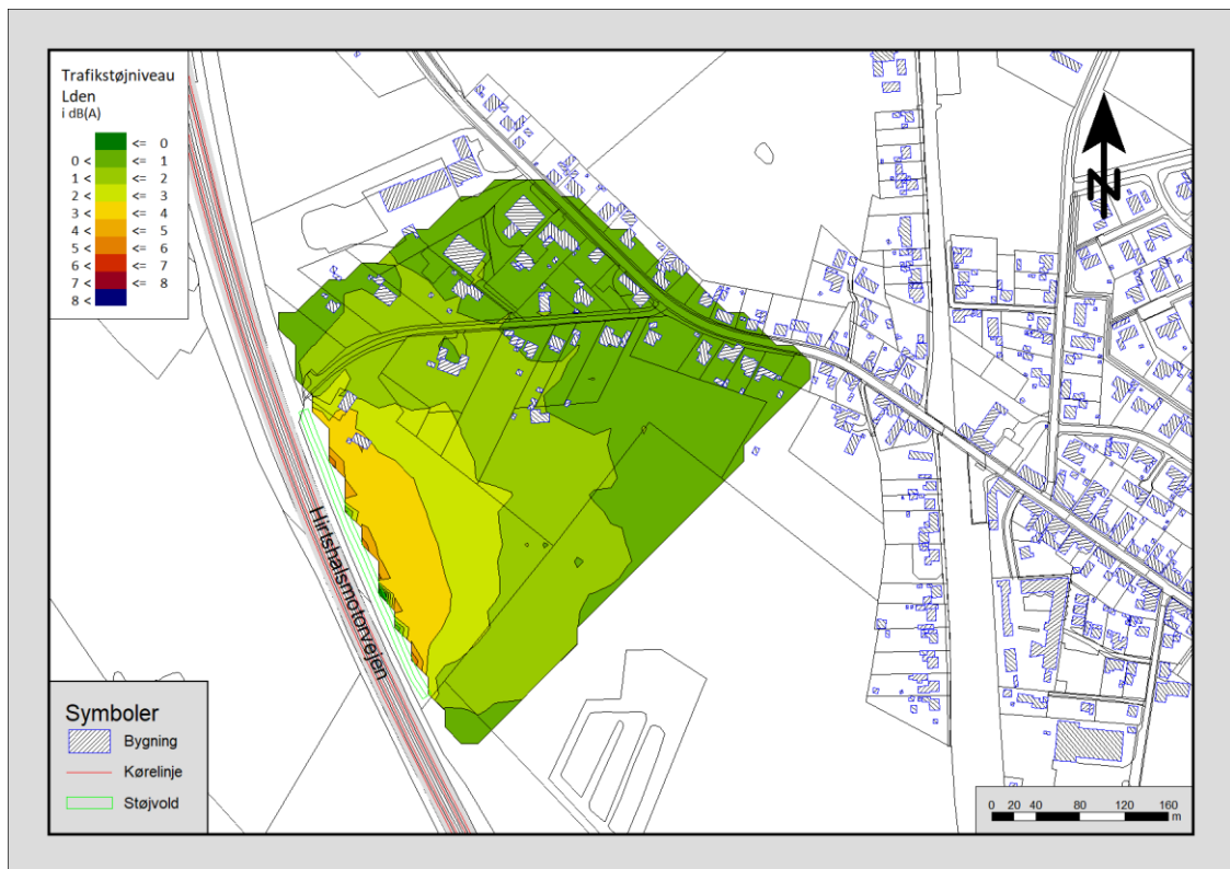
Figur 4b. Ændring med 300 meter lang vold med en topkote 3 meter over vejen
